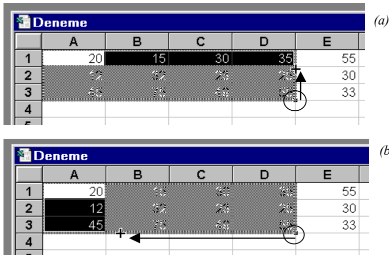
Şekil: 16. Bir grup hücrenin otomatik doldur kutucuğu ile silinmesi. (a) Aşağıdan yukarıya, (b) yukarıdan aşağıya.
